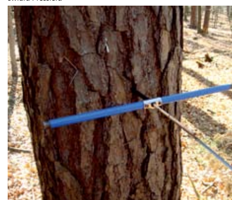
Pobór rdzenia do badań dendrochronologicznych sosny za pomocą świdra Presslera
